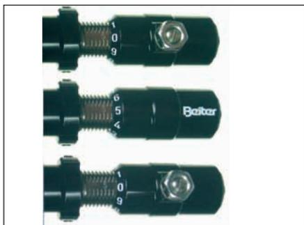
Foto 2: 10 clic del bottone Beiter sono l'equivalente di 1mm di tensione della molla e corsa del pistoncino.
