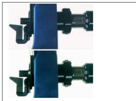
Foto 3: La posizione della freccia nella finestrazione può essere cambiata girando il dado di fissaggio: 1mm per un giro completo, 1/2mm per mezzo giro...
